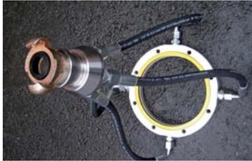
Flange anulari di iniezione per ridurre il calo di pressione causato dal pompaggio di olii ad alta viscosità.
