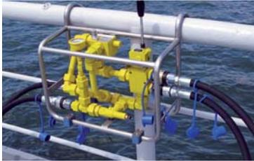
Per operazioni comandate a distanza, alimentati da un power pack o dall'impianto idraulico della nave.
