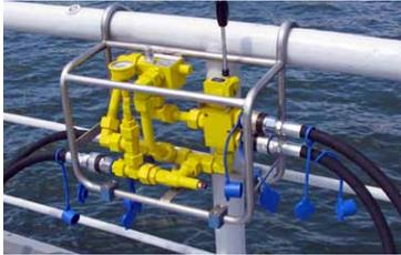
Assure la commande à distance des fonctions de l'écrémeur alimenté par le circuit hydraulique du navire.
