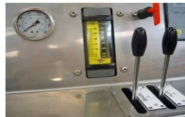
Para hacer funcionar equipo hidráulico adicional conectado a las fuentes de energía FOiLEX.
