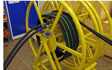
Para un manejo rápido y sencillo de las tuberías hidráulicas.
