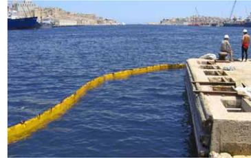
Barrera absorbente de petróleo, de PVC, de flotación, sólida, multiuso, equipada con conectores rápidos y mangos de elevación.
