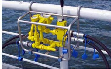
Aportan funcionamiento con control remoto a partir de una fuente de energía o los sistemas hidráulicos del barco.
